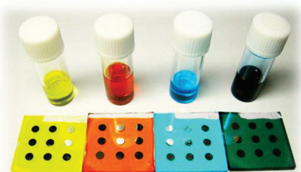
室温で溶液状態の高分子材料を塗布して創るカラフルで軽い次世代太陽電池
